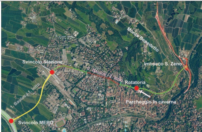
2. Lo sviluppo planimetrico del tracciato della Circonvallazione: in colore verde le tratte scavate al 1° Ottobre 2023
