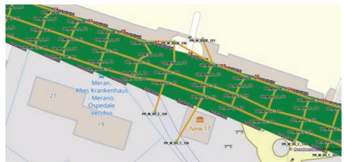
22. Il monitoraggio ottico di Via Goethe: punti di misura e rete di sezioni trasversali e longitudinali
